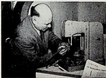
DE SOLDEERMACHINE, het werkstuk wordt van onderen tegen de soldeerstift gehouden
